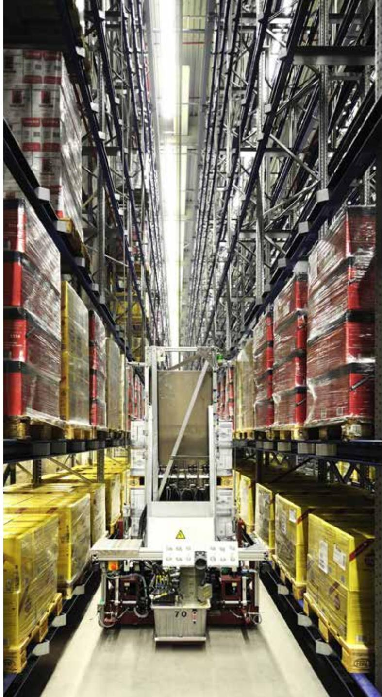
Manuelle Bereiche der Lagerlogistik können wir nahtlos an teil- oder vollautomatisierte Lager-systeme anbinden. Das geht so weit, dass sich in Lagergassen auch gleichzeitig mit Flurförder-fahrzeugen und Regalbediengeräten ein- und auslagern lässt. Oder Wege von Staplern die Gasse des Regalbediengeräts kreuzen. Dies ermöglicht unser flurfreies Regalbediengerät Aviator® mit Regalführung und hängender Hubeinheit.
