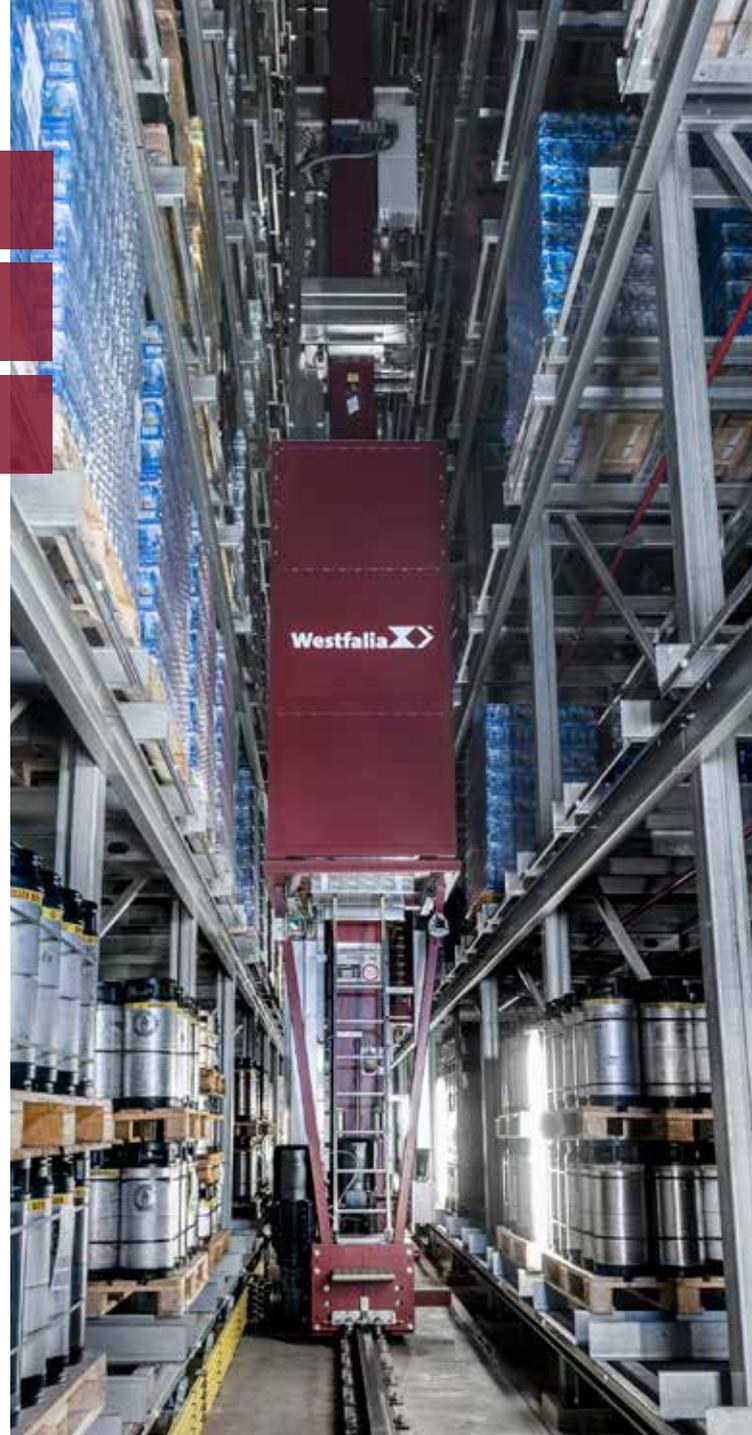
Unsere schienengeführten Regalbediengeräte sind durch ihre höhenflexible Konstruktion für Hochregallager unterschiedlicher Höhen einsetzbar. Flurgebundene Regalbediengeräte fahren einspurig auf Schienen am Boden. Das ermöglicht eine mechanisch stabile Kraftübertragung und Steuerung. Die erforderlichen Nutzlasten, Leistungswerte, Höhenklassen und das Fahrverhalten bestimmen die Bauart unserer flurgebundenen Ein- und Zweimastgeräte.
