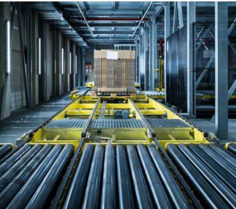
Paletten gehören zu den bedeutendsten Ladehilfsmitteln bzw. Ladungsträgern der Logistik. Wir realisieren **Palettenmagazine** als effektive Elemente eines Materialflusssystems. Sie handeln und stapeln effektiv Leerpalletten und speisen sie automatisch in ein Förder- und Lagersystem.
